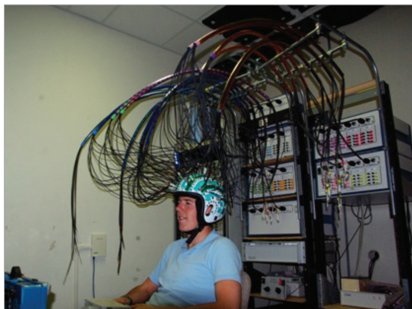
Obr. 4 – Zařízení pro měření Event-related optical signal. (Zdroj: Mathewson, K: Researche, http://www.kylemathewson.com/research/ , staženo: 9. 12. 2014).
